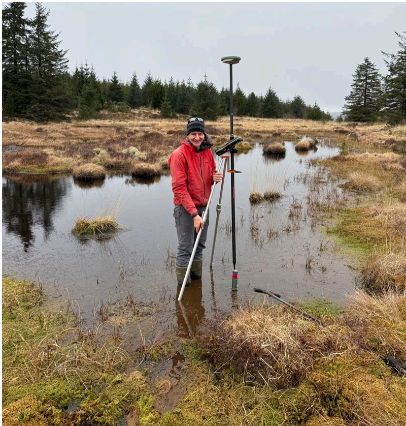
Ffigur 19. Ffynnon fesur newydd-ei-osod yn cael ei arolygu i mewn i ddata OS ac uchder gan Dr Rob Low, hydrolegydd ymgynghorol RhWGF. Cors Gerwyn, Fforest Tywi.
